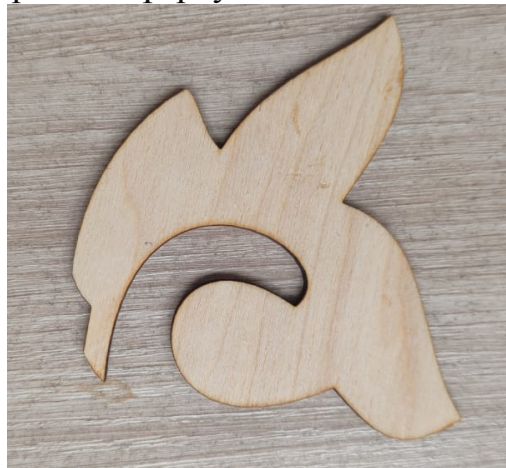
Сурет-2 Лазерлік станокта кесілген фанерадан жасалған түйреуіш дайындамасы
